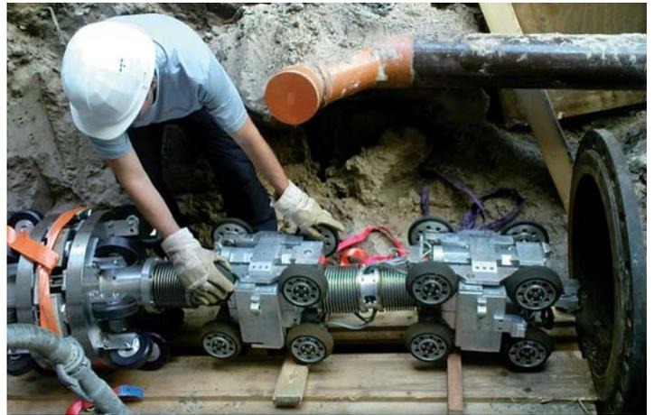
mierung der Rohrleitung hindurch. Ein großer Vorteil dieses Wirbelstromverfahren ist weiterhin, dass die an den Verbindungsflanschen geöffnete Rohrleitung weder gereinigt noch mit einem Koppelmedium geflutet wird. Vorbereitungen, die bei einer Prüfung mittels Ultraschall Voraussetzung sind. Die Kosten für die Vorbereitung sind niedriger und die Zeitersparnis ist erheblich.
