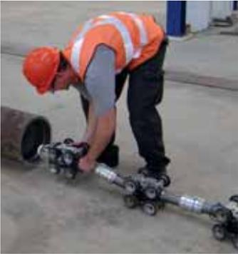
Eine neu entwickelte Lasersoftware zur Innenprofilmessung von Rohren bestand 2010 ihre Feuertaufe. Diese Software sorgt dafür, mit den Standard Video- und Laser-Inspektionsrobotern „INSPECTOR 3000-6000“ eine Innenprofilmessung an Rohren mit einem Innendurchmesser von 130-750 mm durch-
